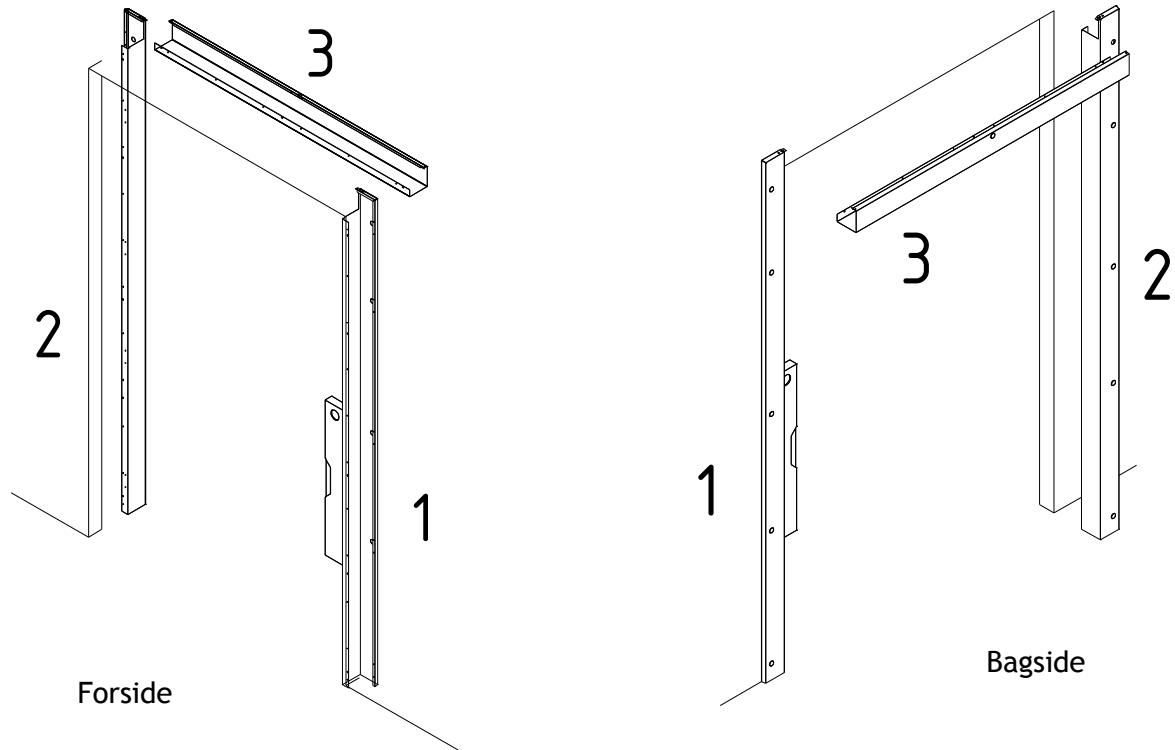
Modkarm holdes til væggen ved hjælp af skruetvinger ( modsat den side af væggen, hvor skydedøren skal monteres). Inden fastgørelse af modkarm kontrolleres, at modkarm er i lod og vater.
