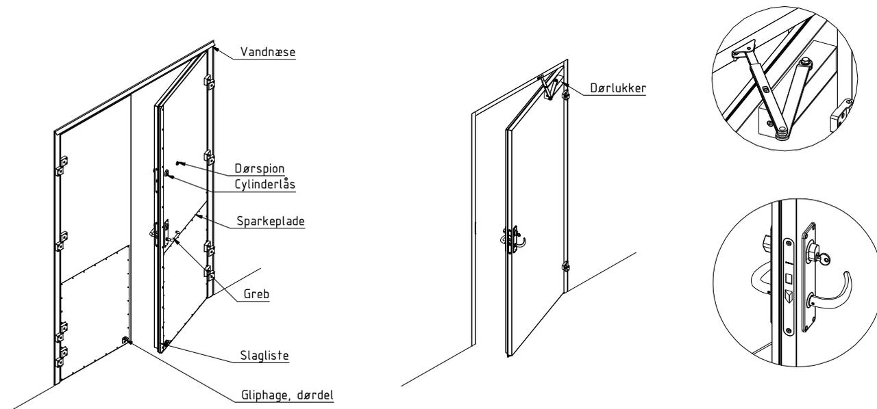
Når karmen sidder fastmonteret i murhullet, og alle mål er kontrolleret, monteres dørbladet på karm i de påmonterede hængsler.
